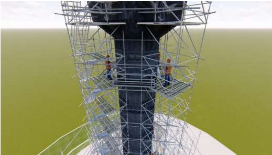
Proyecto y plano de andamio estructural para la Columna de la Independencia (SOBSE- II_UNAM, 2019)
